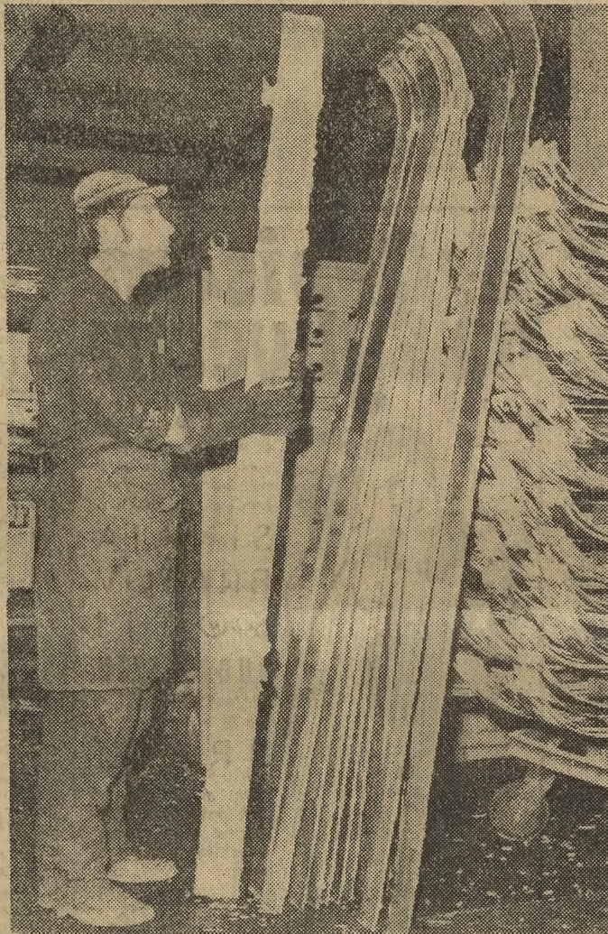
W specjalnych prasach, działających pod ciśnieniem i w podwyższonych temperaturach, metal, drzewo i plastik łączą się w harmonijną całość, dającą najwyższej jakości nartę, tzw. „Rysy Super” — metalowe.
