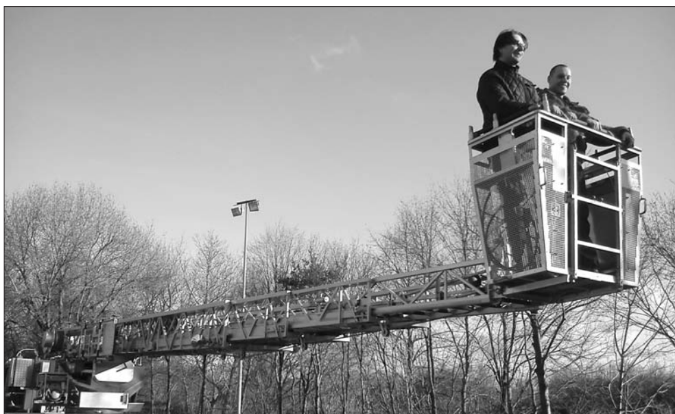
Maksymalna długość wysięgnika to 30 metrów i możliwość podpięcia kosza, w którym mogą pracować trzy osoby
