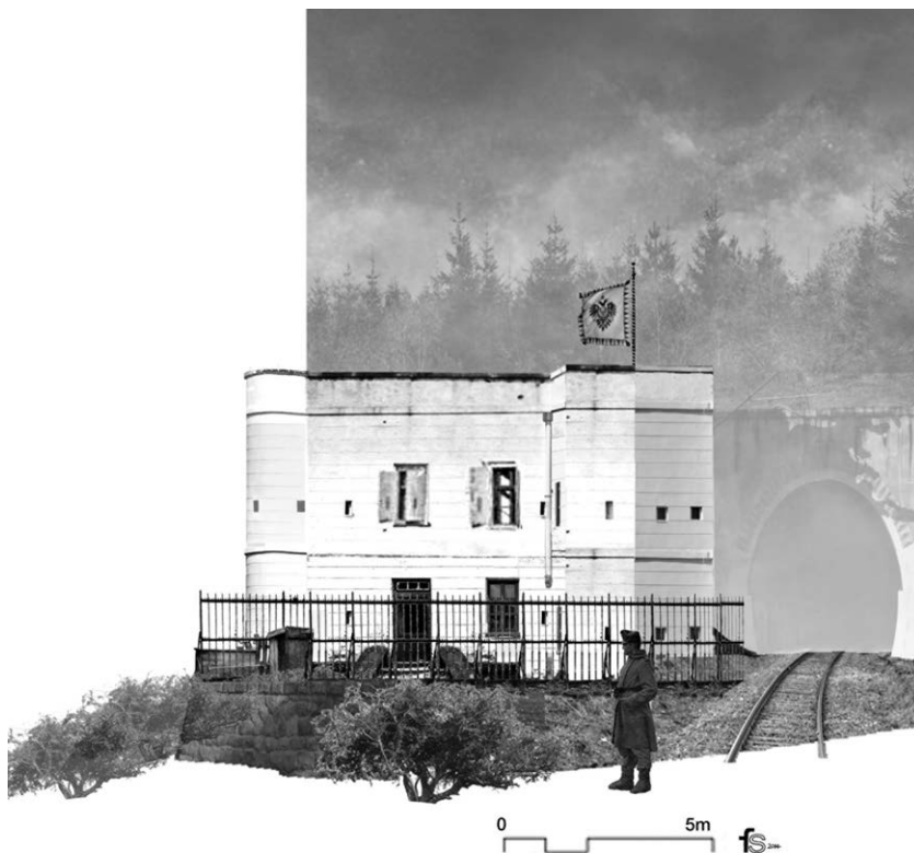
Strażnica przy wschodnim wylocie tunelu koło Kamionki, próba rekonstrukcji pierwotnego stanu elewacji wejściowej (wschodniej). Widok od strony Tarnowa.
