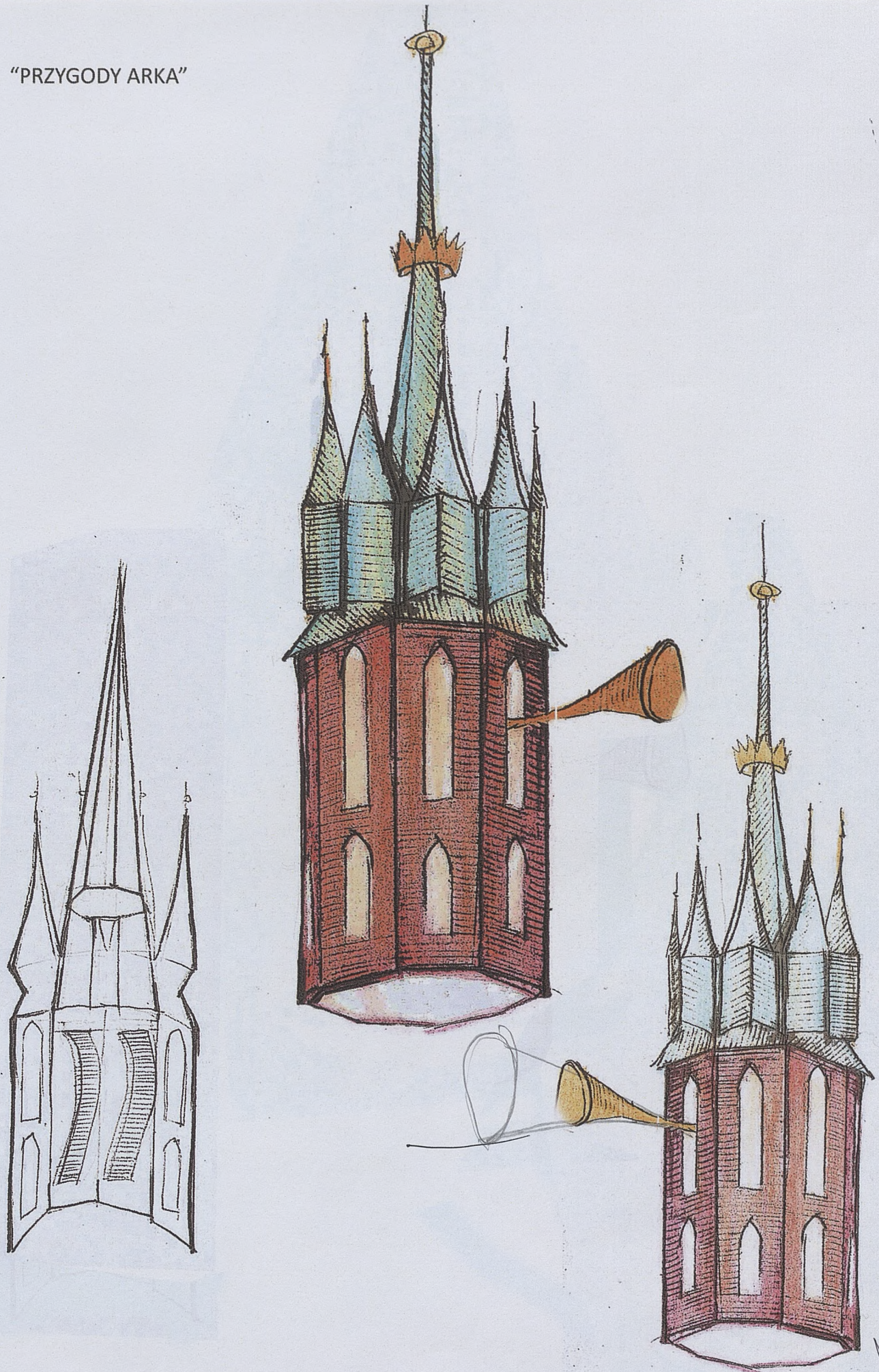
WIEŻA MARIACKA - ELEMENT SCENOGRAFICZNY. MOCOWANY NA SZELKACH JAK PLECAK. Z DODATKOWYMI UCHWYTAMI KONSTRUKCJA METALOWA, POKRYTA LEKKIM SZTYWNYM MATERIAŁEM, MALOWANA
