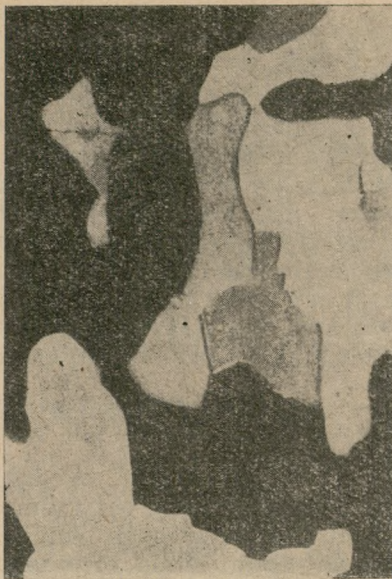
Ryc. 5. Mozaikowa tekstura fazy smektycznej 4-(n-propylmercaptobenzal)-aminoazobenzenu (wg Sackmanna)
