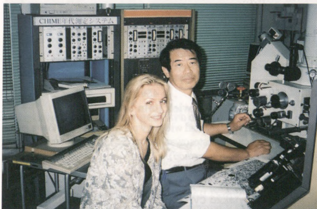
Ryc. 6. Mikrosonda elektronowa w laboratorium Uniwersytetu w Nagoya (Japonia), przy użyciu której każdego dnia wyznaczane są dziesiątki dat dla monacytów metodą CHIME. Na zdjęciu widoczna jest autorka artykułu z Prof. Suzukim.
