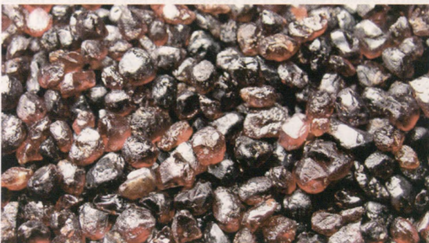
Ryc. 9. Minerale pochodzące z materiału osadowego — jak te granaty z osadów rzecznych z rejonu Dolni Olešnice w Republice Czeskiej — mogą być nośnikami wielu informacji na temat obszarów źródłowych badanych osadów. Szerokość zdjęcia ok. 3 cm.
