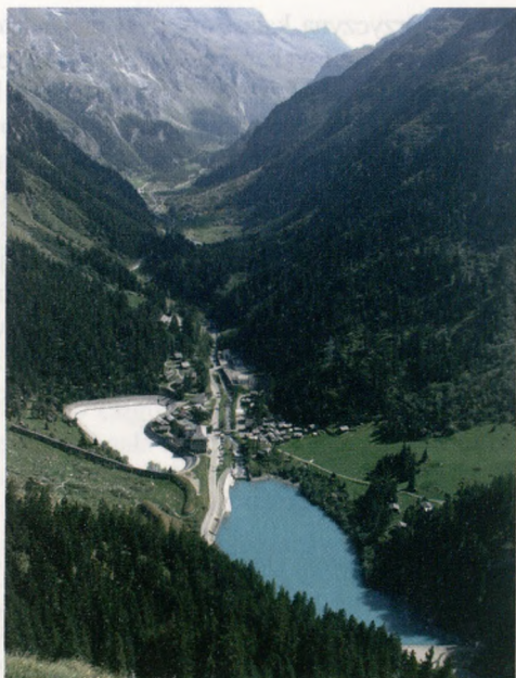
Ryc. 6. Zbiorniki zrzutowe o różnym zabarwieniu wód, które wynika z odmiennych właściwości fizyko-chemicznych wód pochodzących z dwóch niezależnych zlewni. Fot. A. Sobczyk
