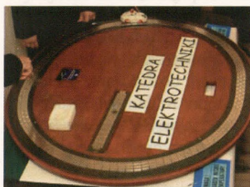
Ryc. 4. Tor magnetyczny do demonstracji zjawiska lewitacji magnetycznej
