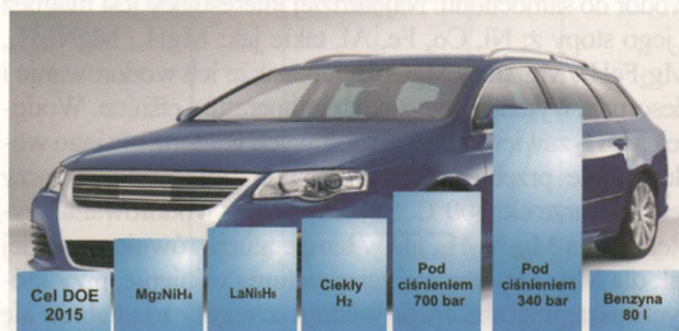
Ryc. 5. Porównanie objętości różnych typów zbiorników na wodór
