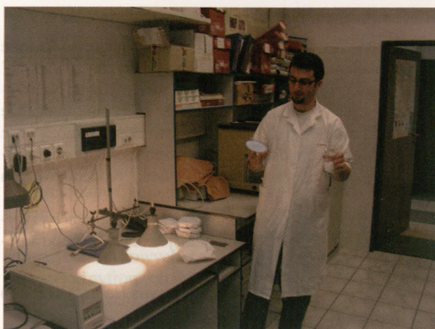
Mgr D. Wodka prezentuje zestaw do testowania fotokatalitycznej aktywności \text{TiO}_2 podczas Dnia Otwartego Instytutu Katalizy i Fizykochemii Powierzchni PAN. Fot. dr M. Szaleniec
