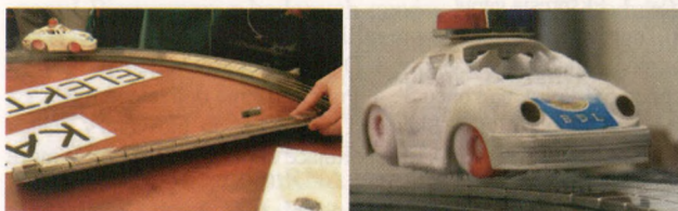
Ryc. 3. Przykład zastosowania nadprzewodników wysokotemperaturowych do demonstracji zjawiska lewitacji magnetycznej pokazywany w laboratorium Katedry Elektrotechniki
