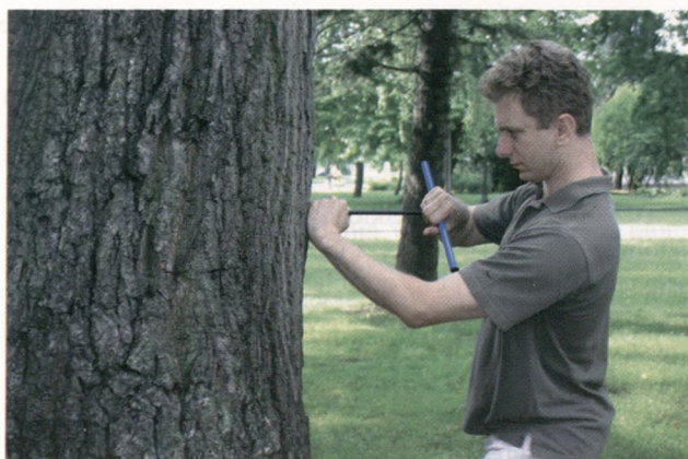
Ryc. 6. Zastosowanie świdra Presslera. Fot. Paweł Zarzyński
