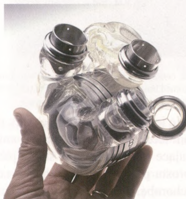
Ryc. 9. Jedna z konstrukcji wciąż niedoskonałego sztucznego serca (rycina ze strony http://dsc.discovery.com/news/2006/09/06/gallery/artificial-heart_zoom.jpg )
