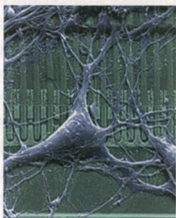
Ryc. 11. Urządzenie do przesyłania sygnałów od żywych neuronów do układów scalonych i odwrotnie jest kluczem do systemów, z pomocą których elektronika mogłaby zastępować fragmenty mózgu (rycina ze strony http://www.abc.net.au/science/news/img/techno/neuronchip290306.jpg )
