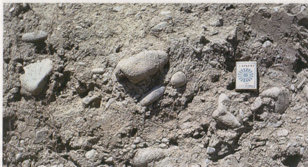
Ryc. 5. Żwir o luźnym upakowaniu zdeponowane w roztokowym korycie środkowej Raby w drugiej połowie XIX wieku. Fot. B. Wyźga.
