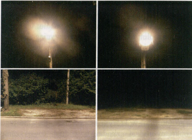
(1) normalny klosz bez osłony (2) klosz z osłoną redukującą emisję światła do otoczenia
